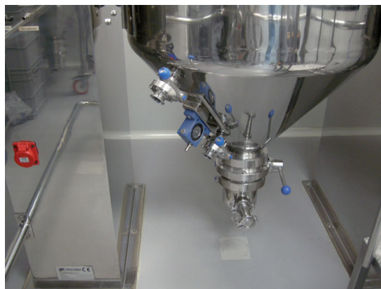
Boca de descarga por sucção
